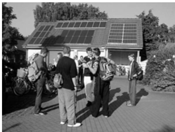
Für ein Einfamilienhaus mit 2500 kWh Strombedarf wird eine Solaranlage von 24 m<sup>2</sup> benötigt, um im Sommer 70% der Stromversorgung mit Solarenergie zu decken, im Winter 30%. Diese schadstofffreie Stromerzeugung spart 3780 kg CO<sub>2</sub> Abgabe in die Luft.
